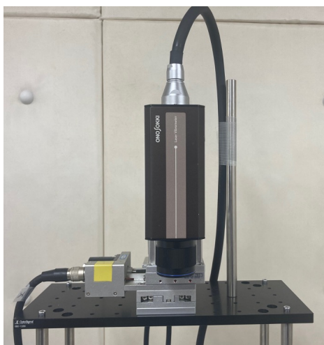
図1 レーザードップラー振動計による振動振幅分布の測定系
